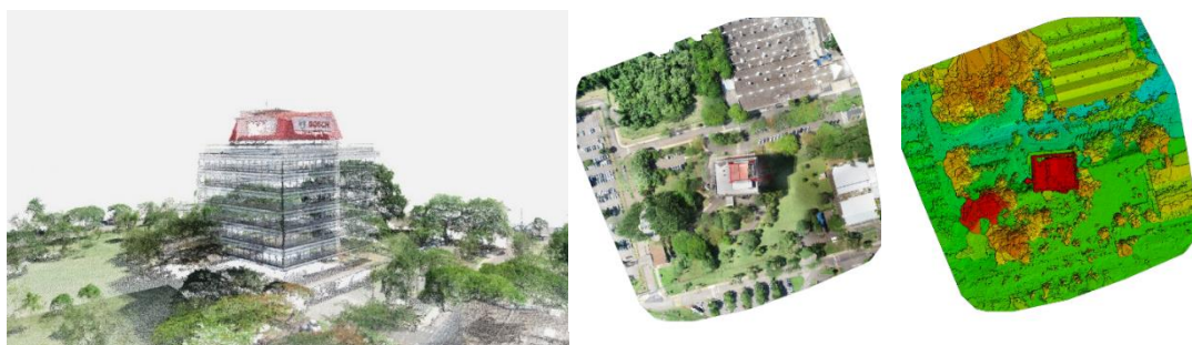
Figura 5: a) Nuvem de pontos do edifício CA401 gerado por aerofotogrametria. b) Ortomosaico e c) Modelo Digital de Terreno (DSM) do edifício CA401
